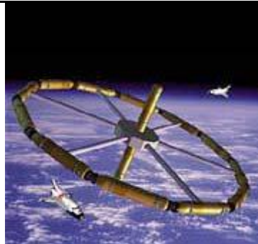
Station aus Shuttle- Außentanks
