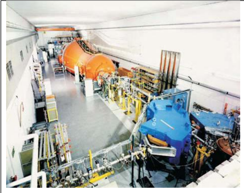
Abb. 4.8: Der 15 MV Tandembeschleuniger des Maier-Leibnitz-Laboratoriums in Garching. Man sieht den Drucktank des Beschleunigers und im Vordergrund den 90°Analysemagneten.
