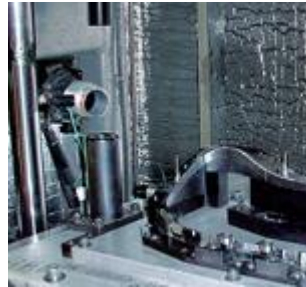
Das Ion Air Cannon System Modell 7292 beseitigt statische Elektrizität und Staub von Tachometergruppen vor dem Zusammenbau.
